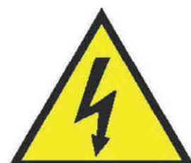
Tensione elettrica pericolosa
